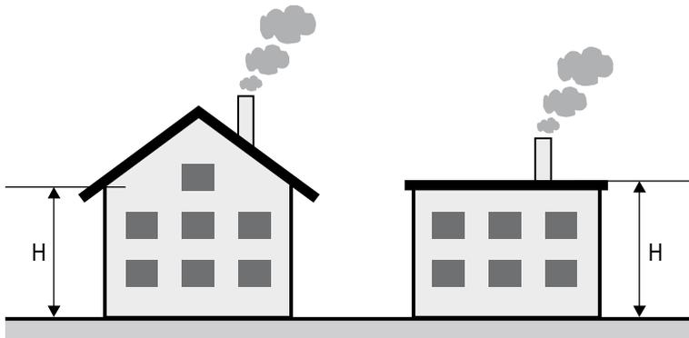
**Tab. 3 > Hauteurs de cheminées au-dessus du niveau d'immission prescrites pour les installations de chauffage de moyenne puissance**
