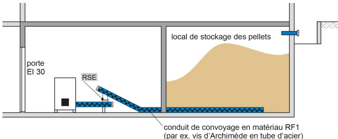
**Chauffage à pellets avec convoyage automatique (système par gravité) de l'entrepôt à pellets dans un réservoir intermédiaire dans le local où est installé le chauffage ou dans la chaufferie [chiffre 6.4 al. 5]**
