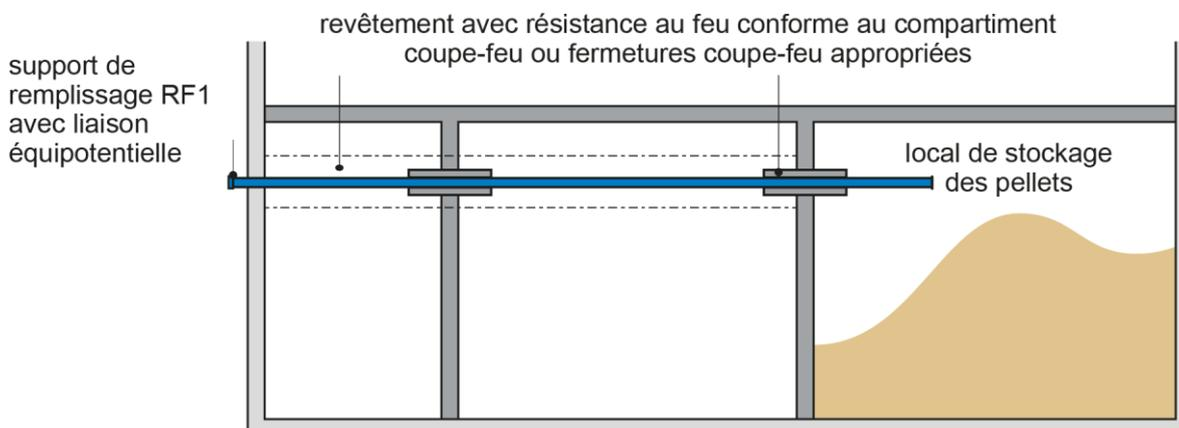
**ad chiffre 6.4 Dispositifs requis pour les chauffages à pellets**
