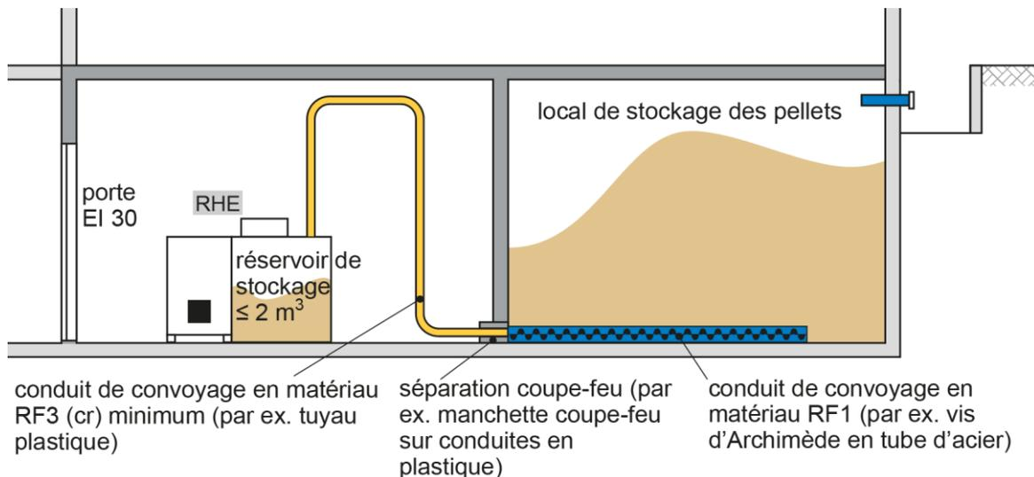
**Chauffage à pellets avec convoyage automatique (mécanique) dans l'entrepôt à pellets et extraction mécanique directement dans l'appareil de chauffage dans le local où est installé le chauffage ou la chaufferie [chiffre 6.4 al. 4]**
