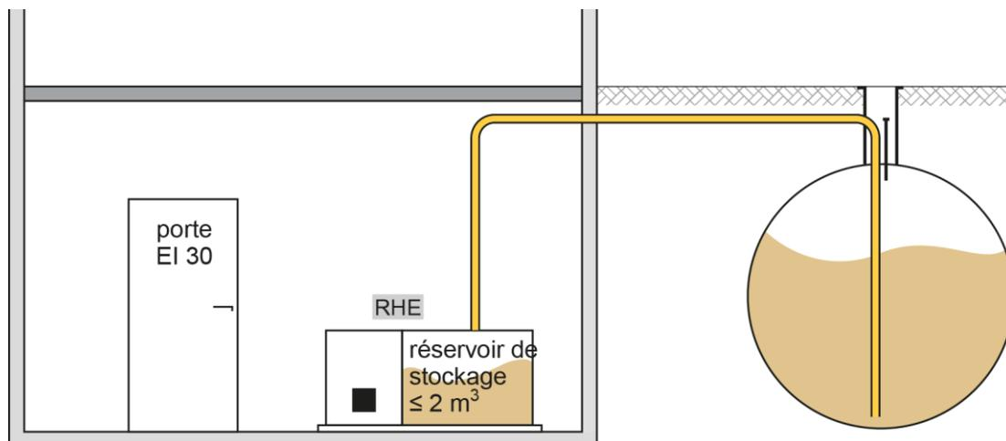
**Chauffage à pellets avec convoyage automatique (mécanique) dans l'entrepôt à pellets et extraction pneumatique dans un réservoir intermédiaire dans le local où est installé le chauffage ou dans la chaufferie [chiffre 6.4 al. 3]**
