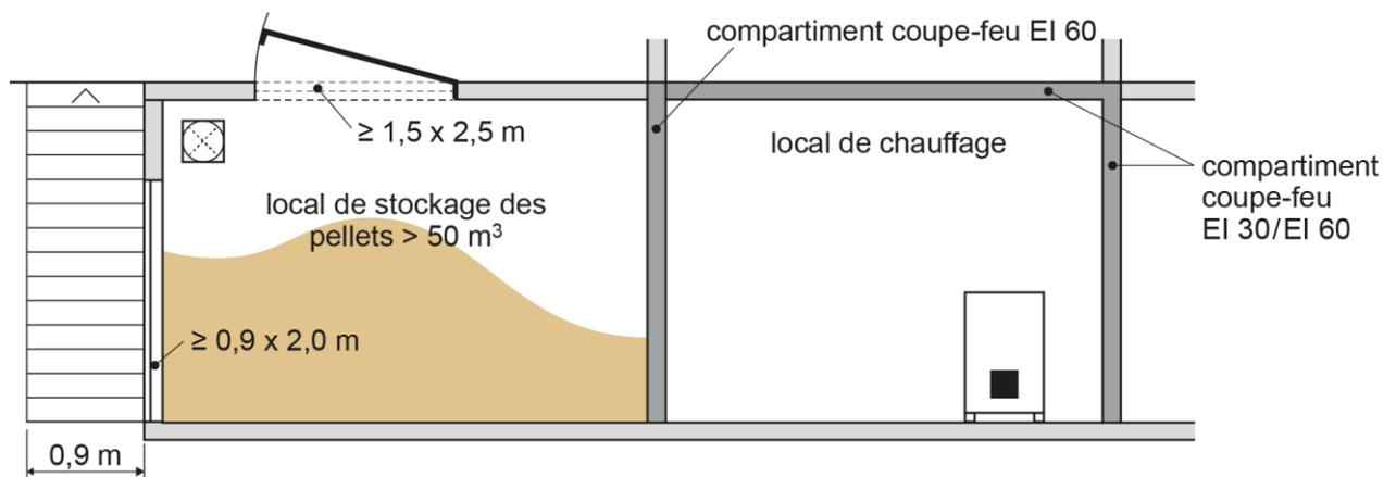
**ad chiffre 5 Chargement des pellets dans les locaux de stockage**
