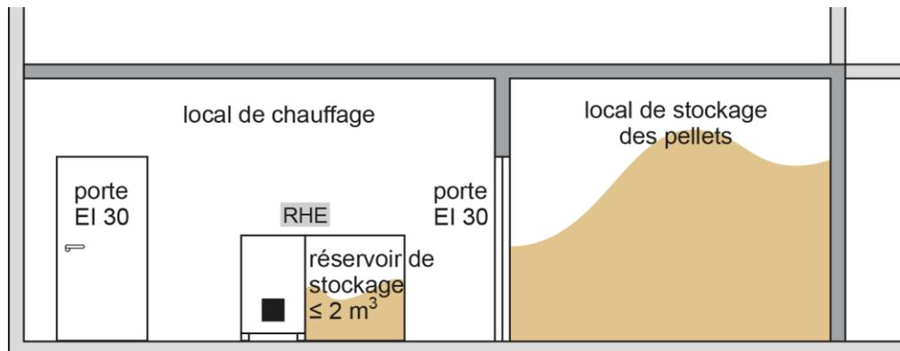
**Chauffage à pellets avec convoyage automatique (pneumatique) dans l'entrepôt à pellets et avec extraction pneumatique dans un réservoir intermédiaire dans le local où est installé le chauffage ou dans la chaufferie [chiffre 6.4 al. 2]**
