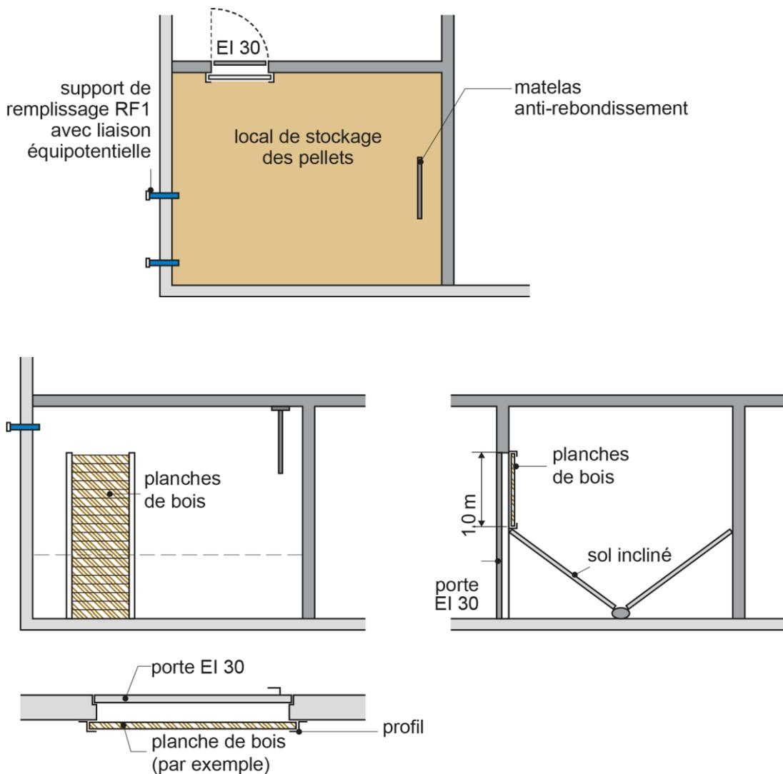
L'ouverture de vidage au-dessus du sol en pente doit être de 1,0 x 0,7 m au minimum. Les planches en bois doivent pouvoir être ôtées depuis l'extérieur quand la porte vers le local de stockage des pellets est ouverte.
